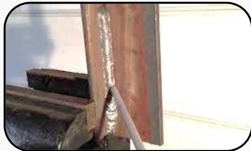
در جوش‌های سربالا (قائم) با دادن حرکت زیگزاگ به نوک الکترود و غلتاندن حوضچه‌ی مذاب، گل جوشکاری را به طرف جلو رانده و از تداخل آن با جوش جلوگیری می‌شود.
