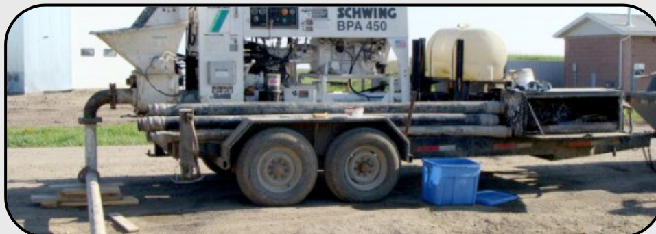
(انتقال بتن با پمپ)
