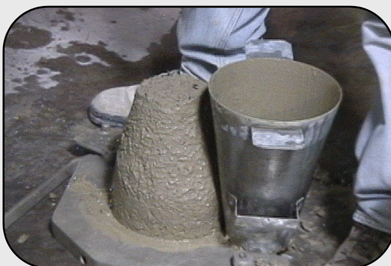
(مشاهده رفتار بتن پس از خارج کردن قالب)
