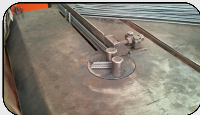
(تهیه خاموت با خم ۱۳۵ درجه با دستگاه خاموت‌زن)
