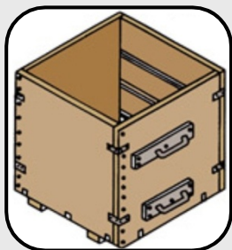
(ظرف مخصوص اندازه-گیری حجمی مصالح)
