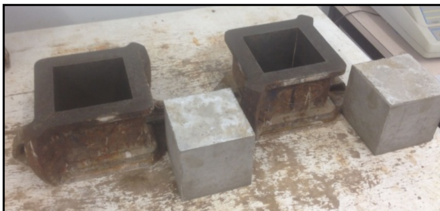
(نمونه برداری مکعبی از بتن)
