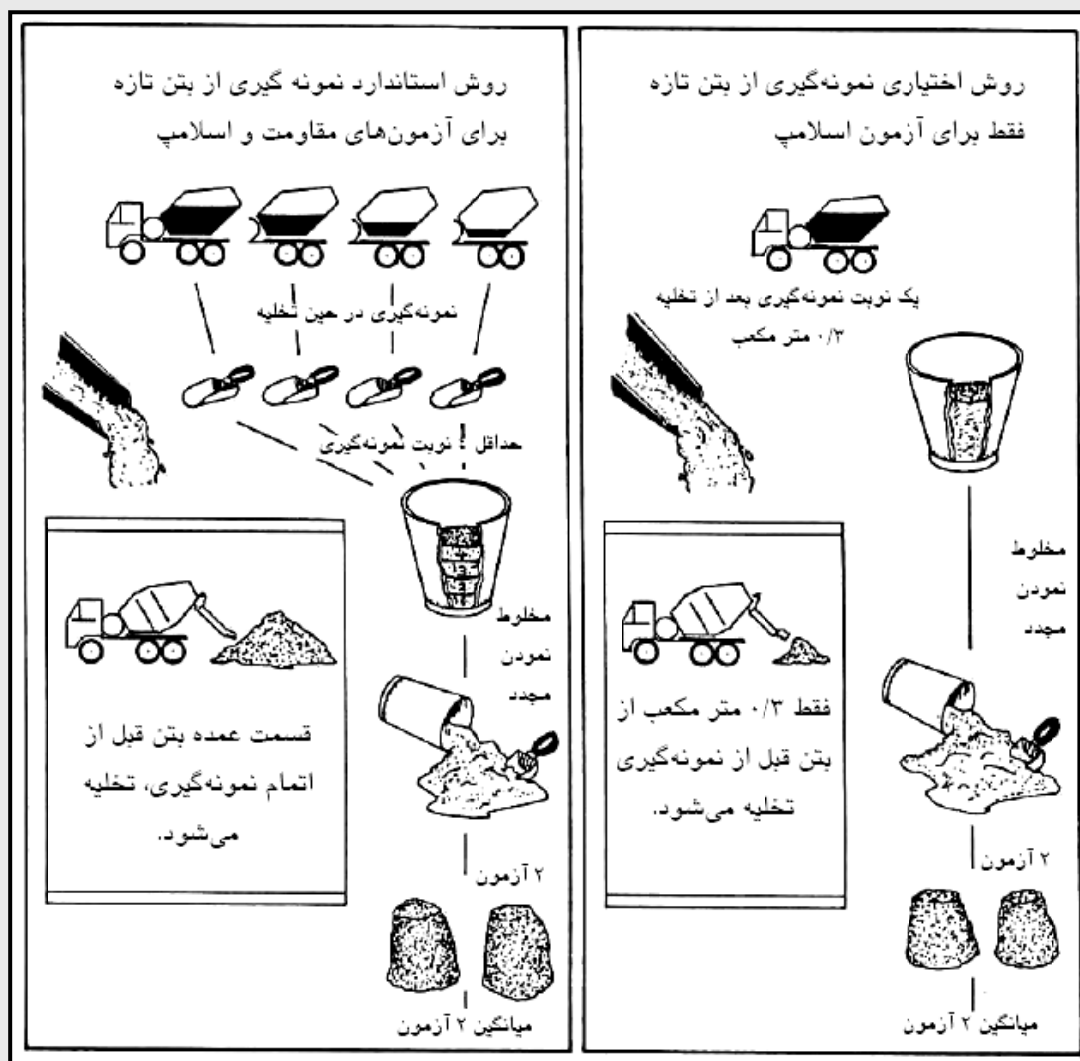
(روند نمونه‌گیری از بتن تازه)
