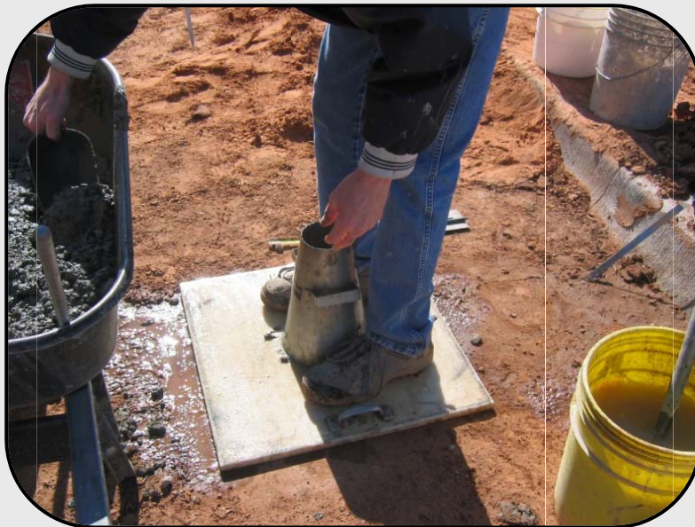
(ریختن بتن در قالب اسلامپ)
