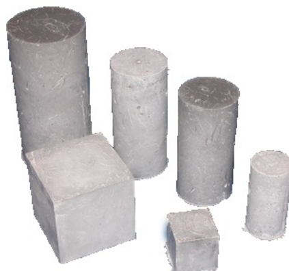
(نمونه استوانه ای و مکعبی)
