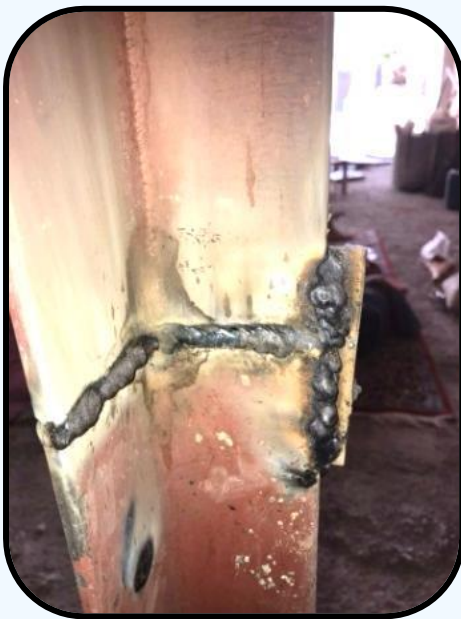
شکل (۲-۳۵) جوشکاری معیوب و غیرقابل قبول نبشی کشی آسانسور
