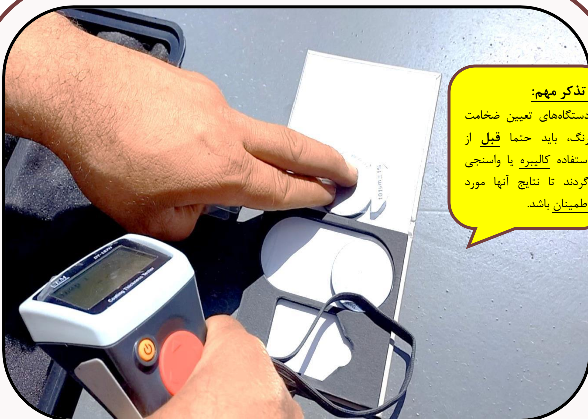
شکل (۱۱-۱۱) کالیبره کردن دستگاه ضخامت‌سنج رنگ
