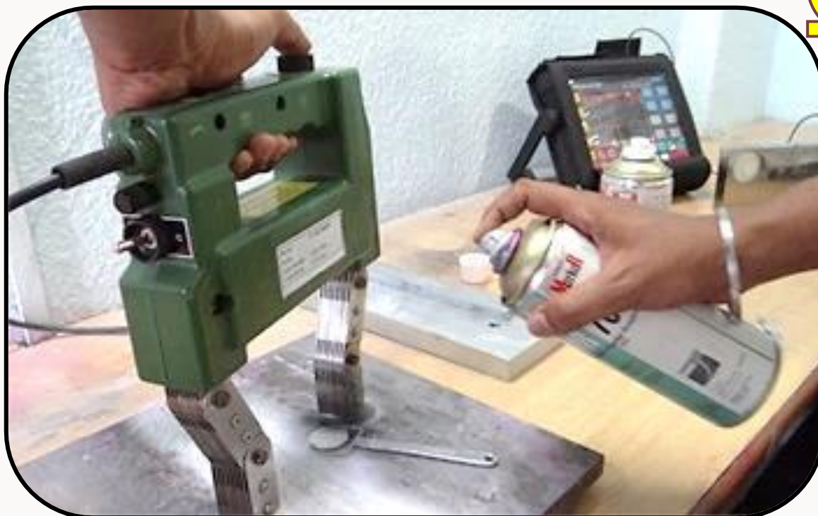
شکل (۹-۲۸) پاشش اسپری براده‌های آهن و ایجاد میدان مغناطیسی با دستگاه یوک
