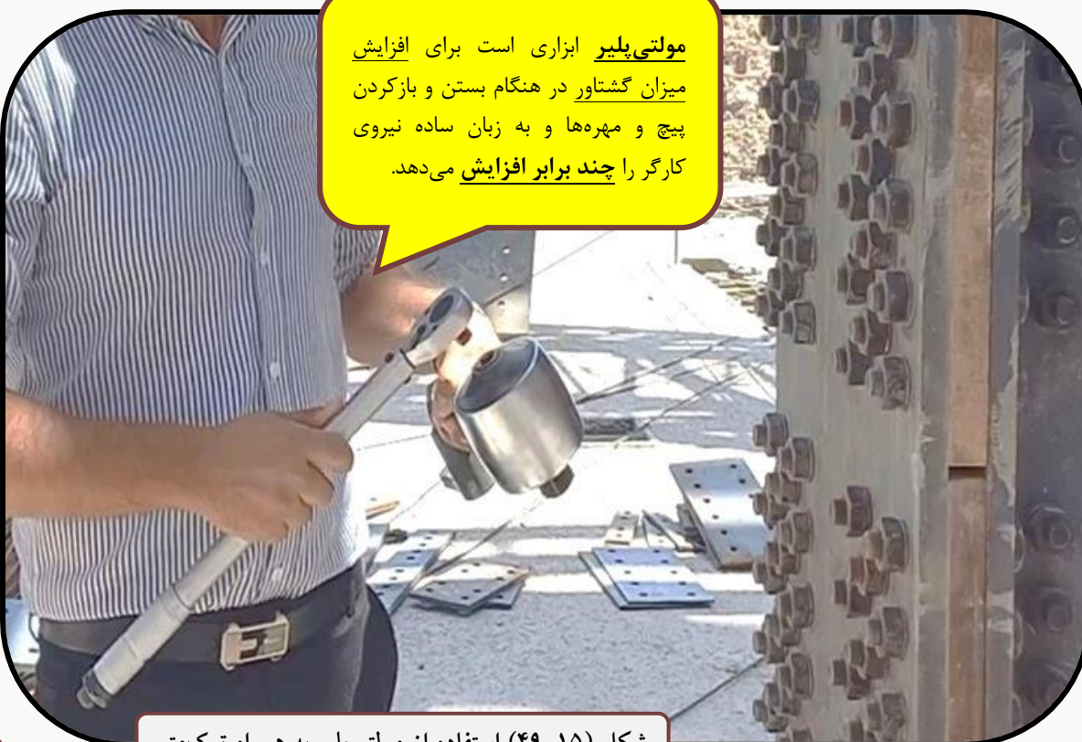
شکل (۴۹-۱۵) استفاده از مولتی‌پلیر به همراه ترک‌متر
