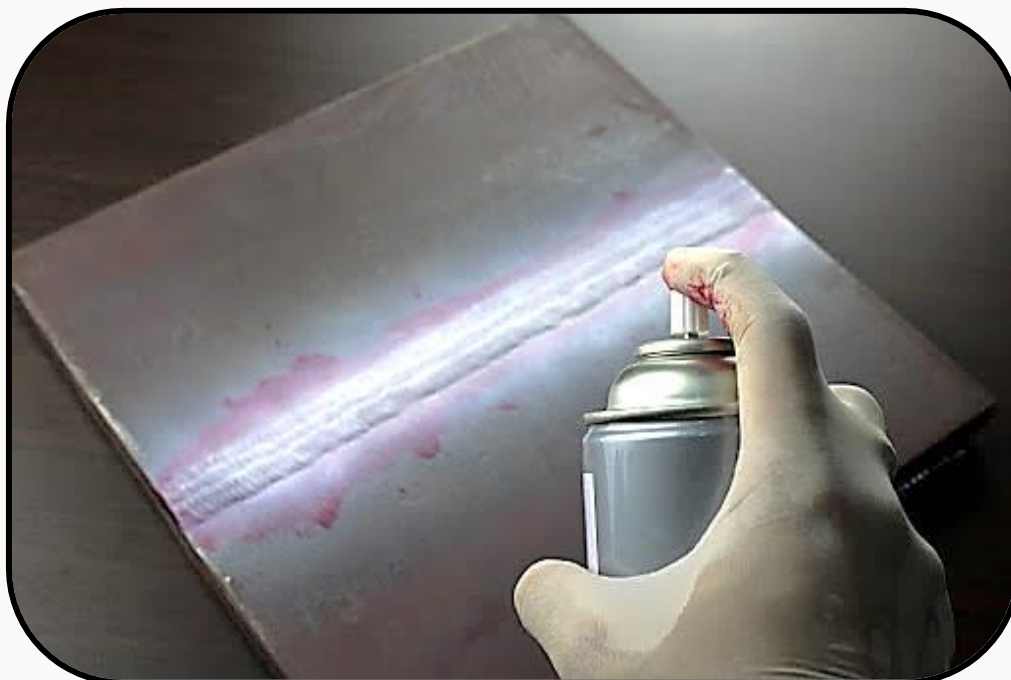
شکل (۹-۲۲) اسپری ماده آشکارساز
