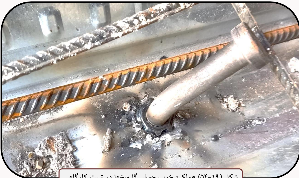
شکل (۱۹-۵۳) تست جوش گل‌میخ‌ها توسط لوله فلزی در کارگاه
