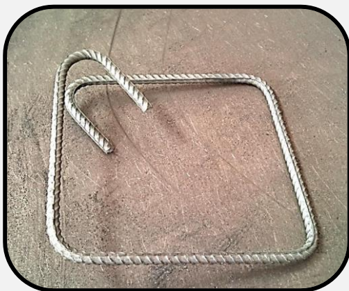
شکل (۹-۴) خاموت با قلاب ۱۳۵ درجه
