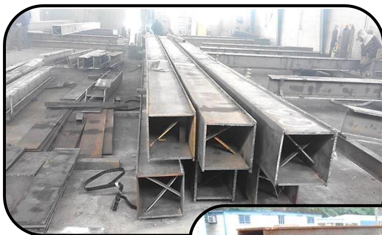
شکل (۸-۱۹) ستون فلزی با مقطع باکس
