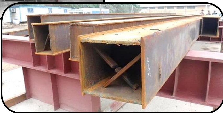
شکل (۸-۱۹) ستون فلزی با مقطع باکس
